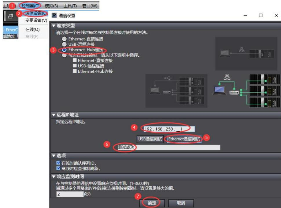
编程电脑与控制器通讯正常后，把控制器进行在线，把 AU7 731-8CT22 模块扫到 Sysmac Studio 上，如下图所示：
