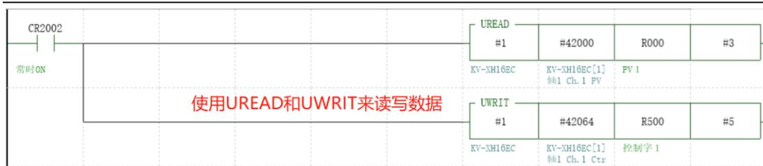
6、将程序下载到主机监控数值。将 SM693H-1TH 的通道 1 短接，热电偶接入到通道 2，可都上来数值分别为 317 和 304。对通道 1 设置温度为 800，然后通过控制字写 1（即通道 1PID 运行），通道 1 的状态字变为 18（PID 运行及正在加热），同时 SM693H 的 Q0.0 亮起。
