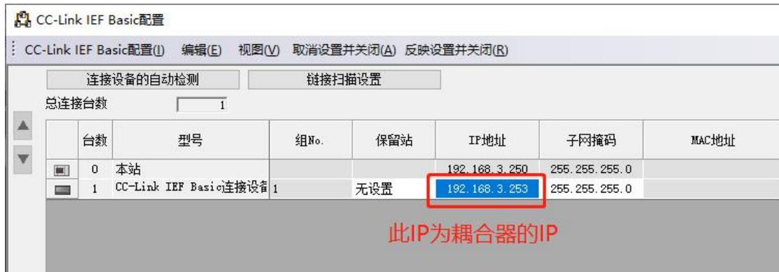
设置完成后，点击【反映设置并关闭】关闭此配置窗口。
