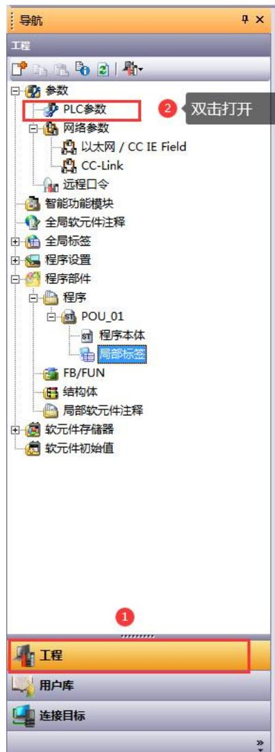
(4) 在内置以太网端口设置配置 CPU 的地址等相关参数
