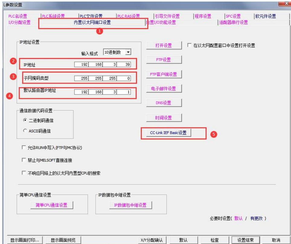
(5) 选择[PLC 参数]→[内置以太网端口设置]→[CC-Link IEF Basic 设置]→[网络配置设置]→[ CC-Link IEF Basic 设备]，添加 CC-Link IEF Basic 设备后在 IP 地址写入耦合器的 IP 地址，“点数”建议选择 256 点（占用 4 站），配置完成后选择[反映设置并关闭]，之后每栏选择[设置结束]配置才生效。
