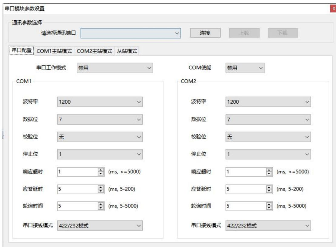
**串口工作模式：**禁用、Modbus 主站、Modbus 从站、自由口 4 种模式；
