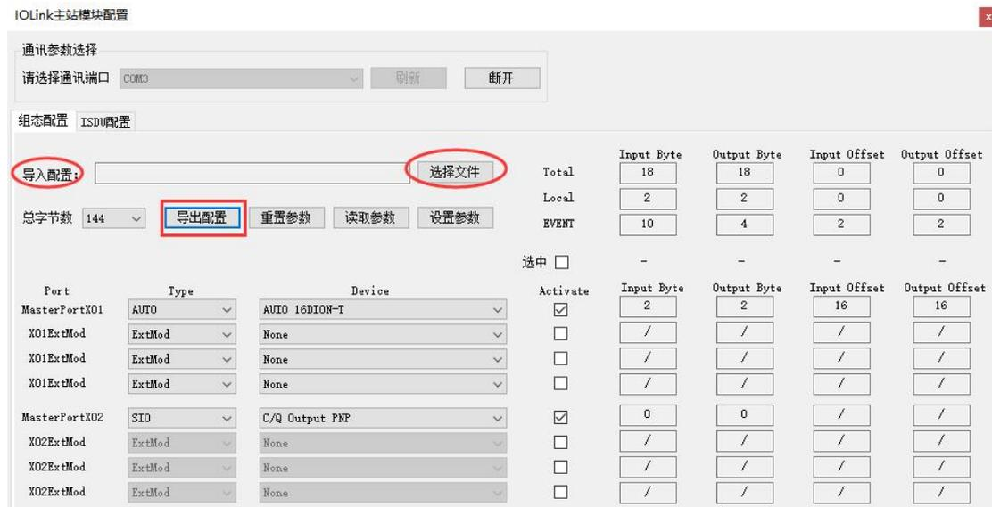
(8) ①：重置参数：将所有设置参数复位，如果不点击重置参数，模块断电上电还是会保持上一次的配置。
