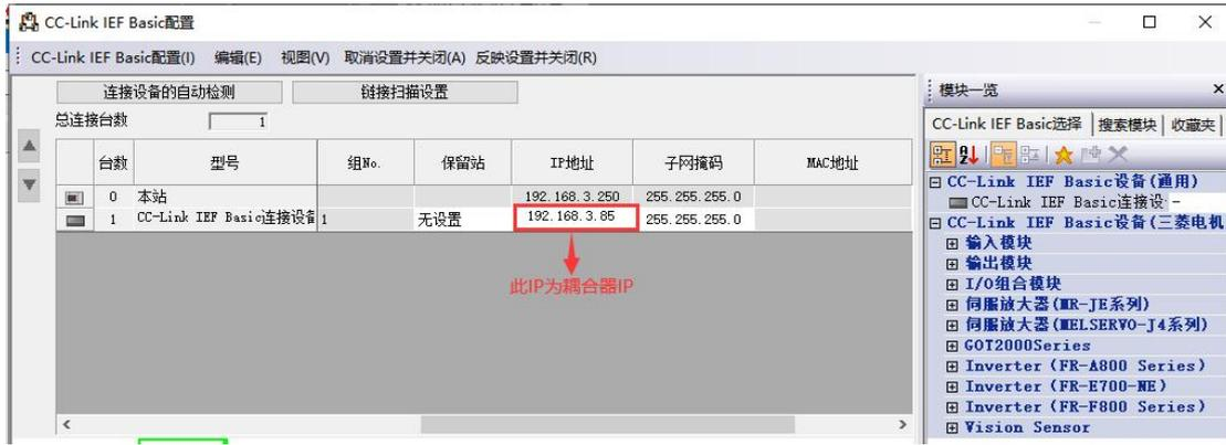
设置完成后，点击【反映设置并关闭】关闭此配置窗口。
