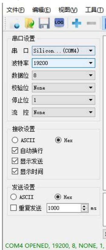
AU7 841-COM22-H 与 TwinCAT3 通讯正常后，查看 AU7 841-COM22-H 与 Serial Port Utility 通讯是否正常，AU7 841-COM22-H 模块上的 RX1、TX1 指示灯在不停的闪烁，则说明有数据进行收发，两个状态都显示正常后，即可进行数据监控。
