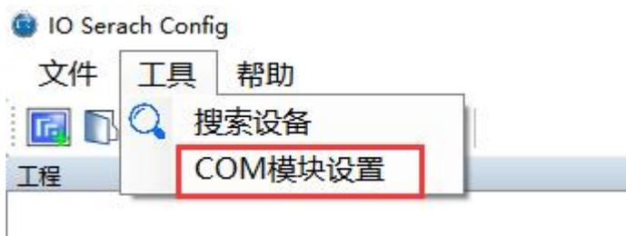
进入配置界面后，选择正确的通讯端口，连接成功后可以对 AU7 841-COM22-H 进行上下载：
