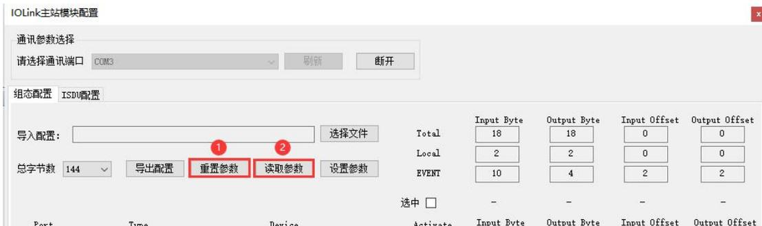
(9) 参数设置后，后自动计算对应字节参数：
