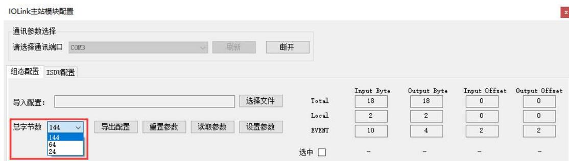
(4) 根据所使用的 IO-Link 接口进行相关配置，配置完成后需勾选更改的配置，或勾选选中框，此时会将改动后的参数进行勾选。
