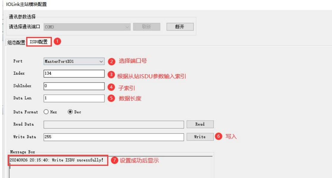
在博图中根据对应地址输入数值（地址仅供参考，具体地址根据实际使用配置）
